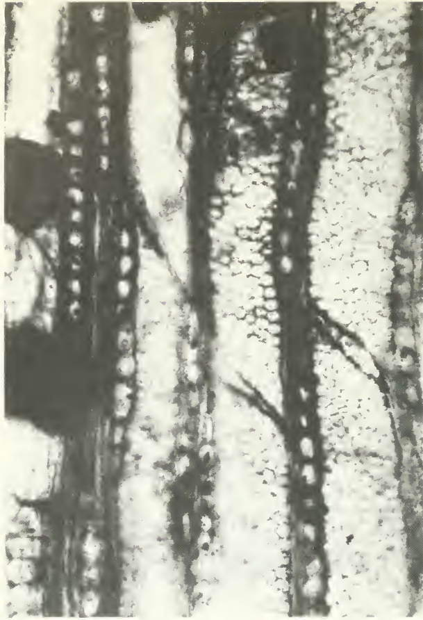
Abb. 13: Tangentialschliff. Einreihige, homozellulare Holzstrahlen, Durchbrechungen einfach, polygonale Gefäßtüpfel. 1979 XV 511; x 230
